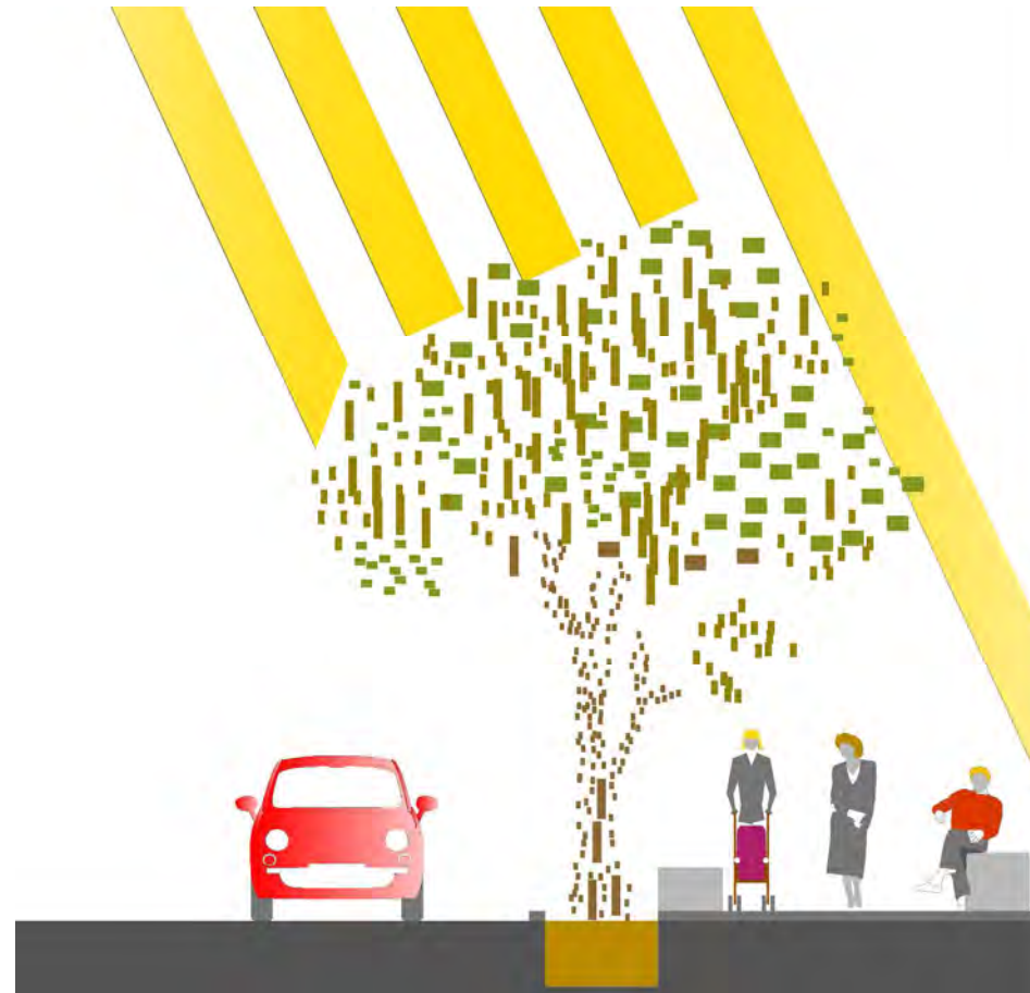
Zone di ombra verso zone in cui sostano i pedoni.
