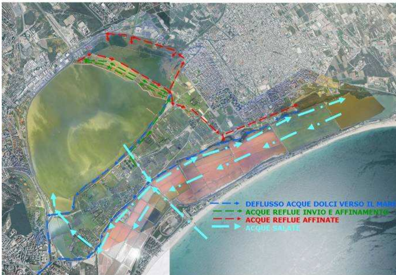
Figura 25 Rappresentazione dei diversi sistemi di circolazione delle acque
