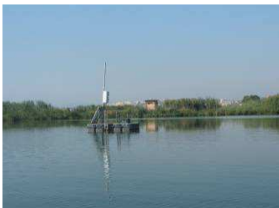
Foto 29 Stazioni di qualità con fluorimetro SM01 (Vasca 1 del Bellarosa Minore) e SM10 (vasca 3 del Perdalonga)
