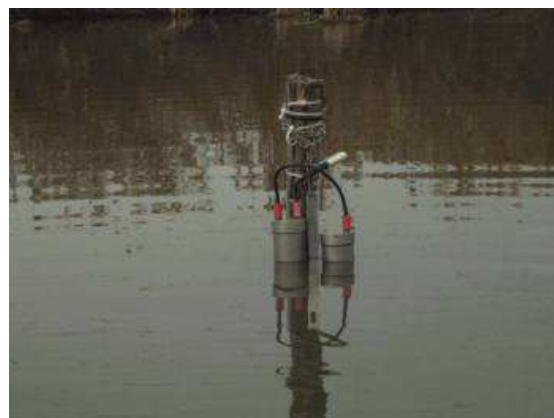
Foto 29 Stazioni di qualità con fluorimetro SM01 (Vasca 1 del Bellarosa Minore) e SM10 (vasca 3 del Perdalonga)
