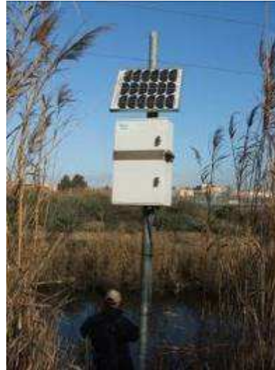
Foto 27 Stazioni di livello a ultrasuoni e a pressione (SM04L4 ed SM03L3)
