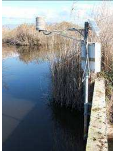
Foto 27 Stazioni di livello a ultrasuoni e a pressione (SM04L4 ed SM03L3)
