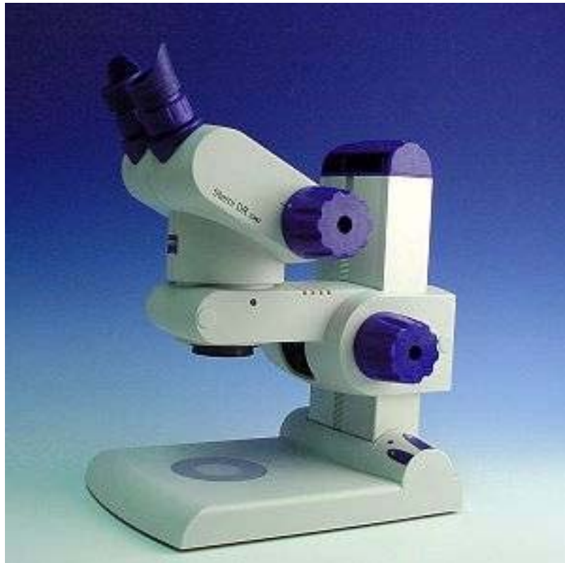
Figura 35: Microscopio utilizzato per il riconoscimento composizionale del sedimento. Modello Zeiss Stemi DR 1040
