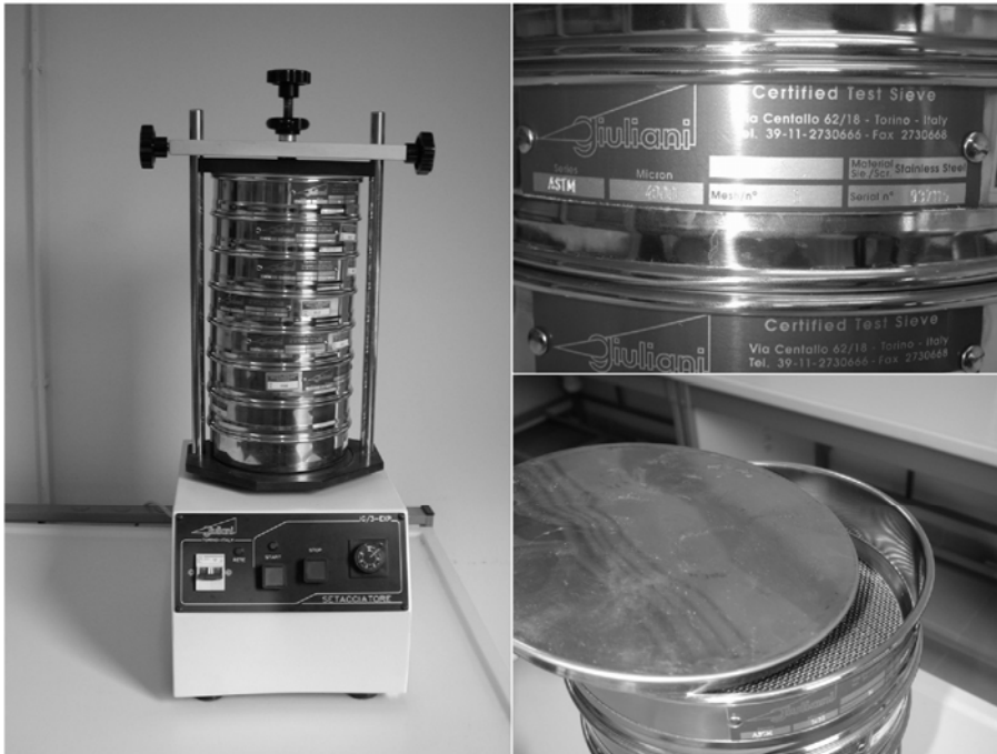
Figura 34: (Immagine rappresentante la batteria dei setacci inseriti nella macchina di agitazione meccanica. foto Longhitano)
