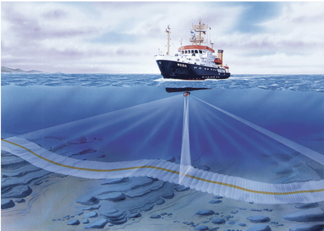
Figura 30: raffigurazione schematica di una "spazzata" multibeam: essa consente l'acquisizione contemporanea di più dati batimetrici permettendo una copertura totale del fondale. (fonte: geoinformatics)
