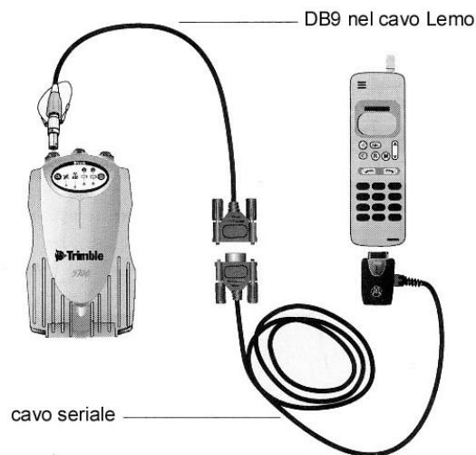
Figura 12: collegamento GPS Rover con modem GPRS per consentire la comunicazione tra le due stazioni.
