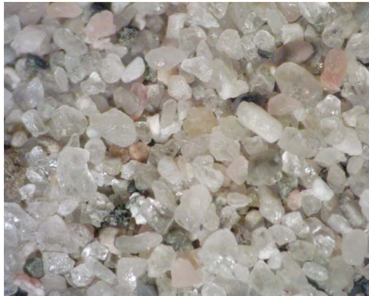
Figura 32: foto del campione P01 visto al microscopio binoculare. Ingrandimento 20x
