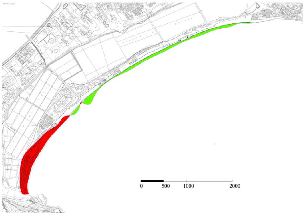
Figura 27: Rappresentazione sintetica degli avanzamenti (in verde) e degli arretramenti (in rosso) registrati tra il gennaio 2004 ed il settembre 2007. Le distanze degli arretramenti/avanzamenti della linea di riva sono stati esaltati con fattore 10 al fine di una più efficace rappresentazione.
