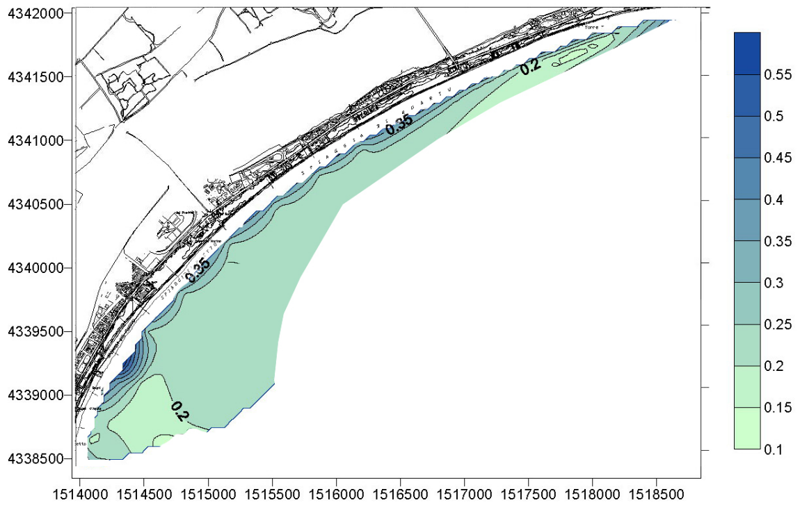
Figura 43: Mappa della distribuzione del D 50 [mm] calcolato dalle misure dei campionamenti effettuati nel ottobre dicembre 2003. (fonte rivisitazione figura 9: Rapporto n. 3. Modimar, 2004)
