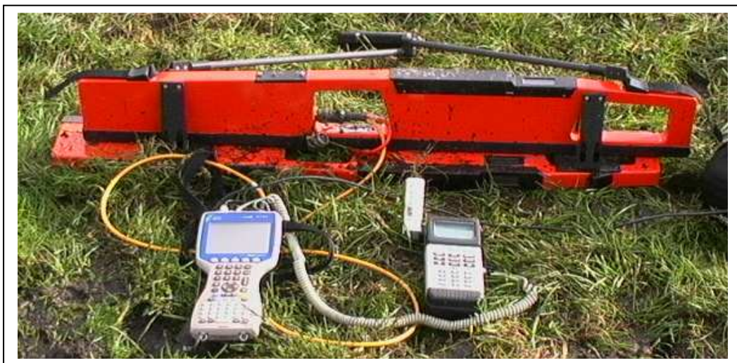
Figura 17 – L'EM38DD configurato e allestito per una prospezione geofisica.
