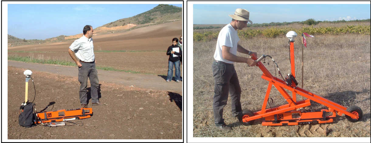
Figure 22 e 23 – Strumentazione geofisica condotta a mano e con l'ausilio del sistema di trasporto, rispettivamente.
