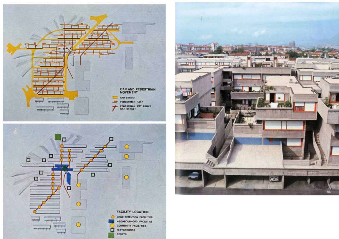
Figura 2. A sinistra planimetrie del progetto del villaggio Matteotti. Sono illustrati in alto i sistemi della viabilità generale definito dalla maglia dei percorsi separati e differenziati. In basso il sistema delle attrezzature e loro localizzazione. A destra foto del villaggio Matteotti nella seconda metà degli anni settanta. Fonte: De Carlo G. (1977), “Alla ricerca di un diverso modo di progettare” in Casabella n°421.
