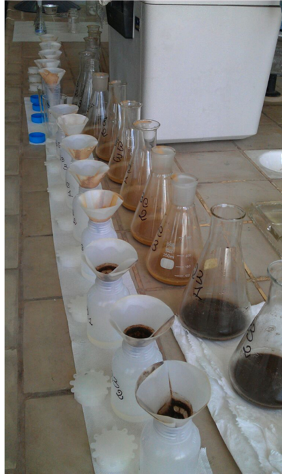
Figura 6.7: campioni di substrati in laboratorio durante l'analisi per la determinazione del contenuto di Ca, Mg, K e Na.
