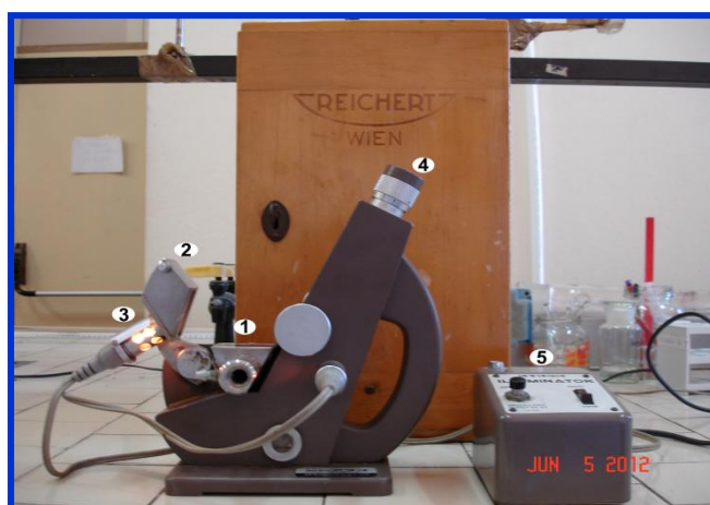
Figura 4.1. Refrattometro di Abbe. Lo strumento è composto da (1) un prisma inamovibile ed (2) uno mobile, (3) una sorgente luminosa (589 nm), (4) un oculare e (5) un interruttore elettrico con display per la visualizzazione dell'indice di rifrazione.
