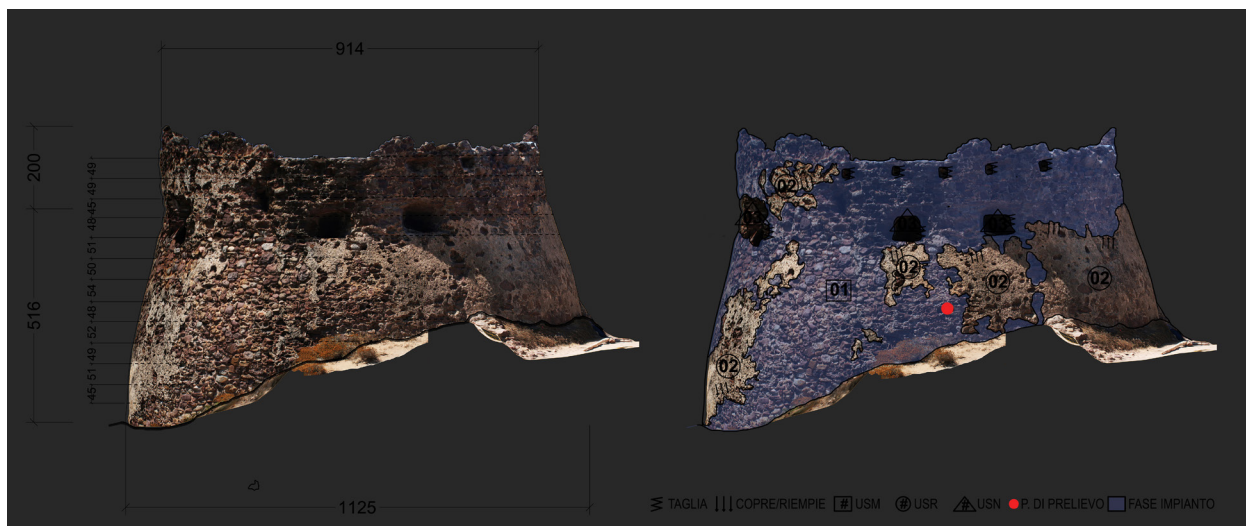
Fig. 39. Ricostruzione del modello tridimensionale con indicazione dei cantieri e rilievo stratigrafico della torre Bianca.
