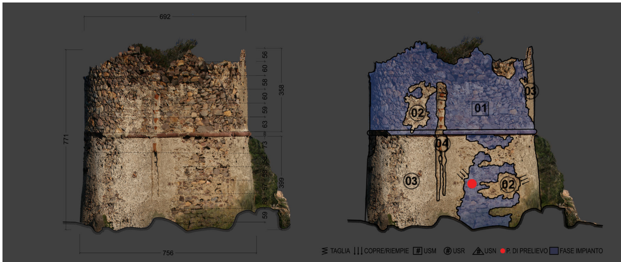
Fig. 34. Ricostruzione del modello tridimensionale con indicazione dei cantieri e rilievo stratigrafico della torre di Ischia Ruggia.
