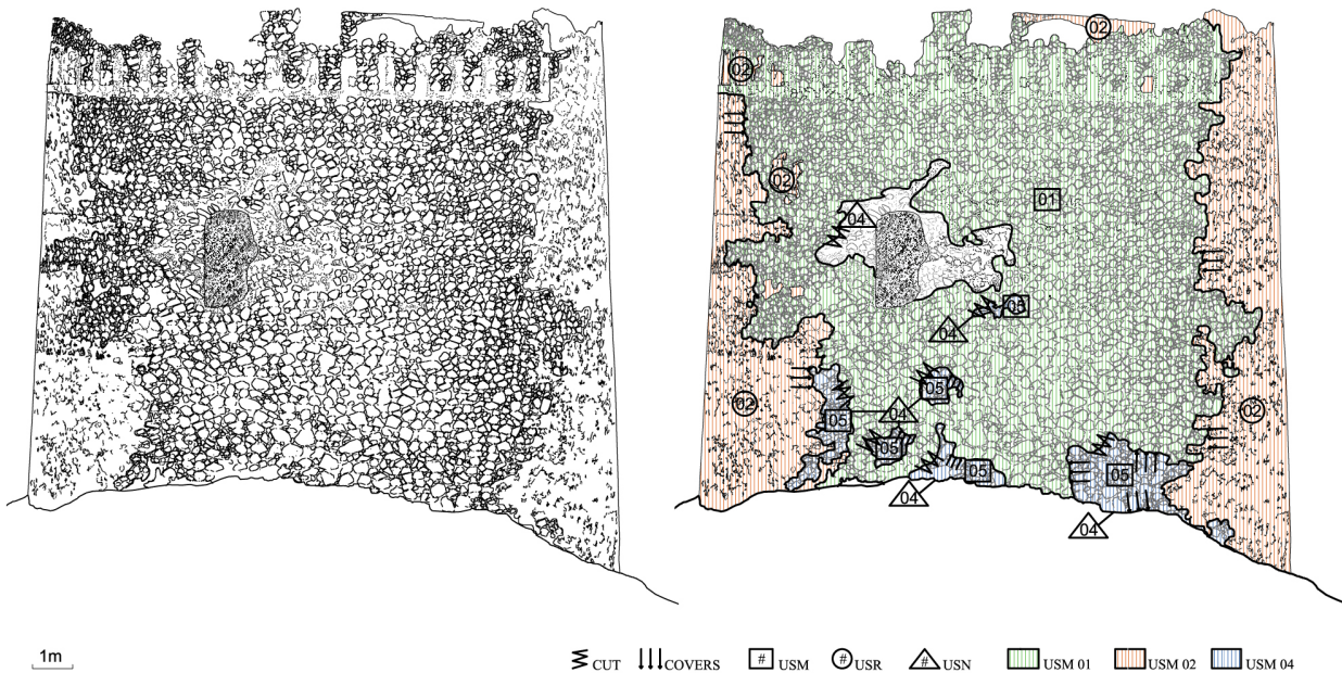
Fig. 15. Analisi stratigrafica relativa alla torre di Isola Rossa a Trinità d'Agultu.
