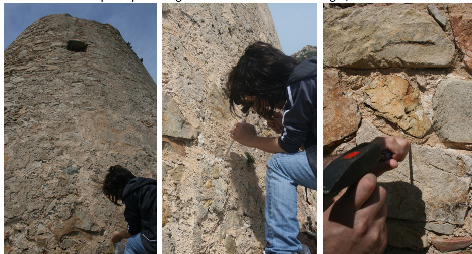
Fig. 18. Fase di campionatura delle malte nella torre di Capo Boi (Solanas, Sinnai).
