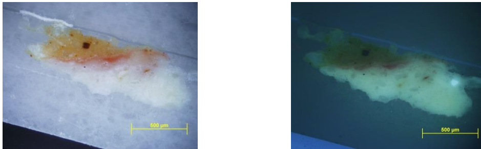
Figura 18 Sezione stratigrafica del campione giallo TPC13 al microscopio ottico in luce visibile e UV.
