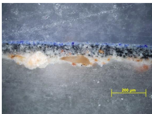
Figura 62 A sinistra SN1: sezione stratigrafica in luce visibile. A destra: spettro SEM-EDS acquisito sui cristalli blu del campione SN1.
