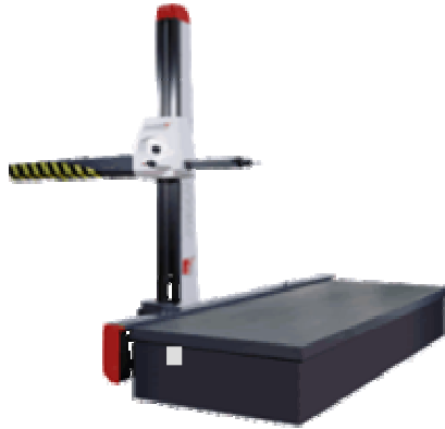
Fig. 2.5. Horizontal arm type CMM
