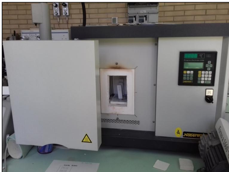
*Figura 55 - Muffola Narbertherm e campioni prismici in marmo.*
