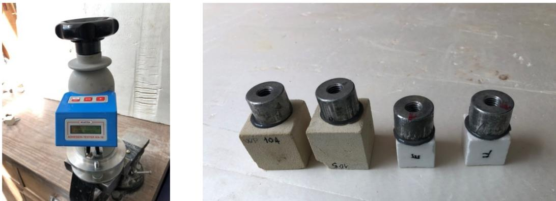
Figura 70 - Strumento per effettuare le misure di trazione (sinistra) e i tronchetti in acciaio incollati alla superficie di campioni di marmo e biomicrite (destra).
