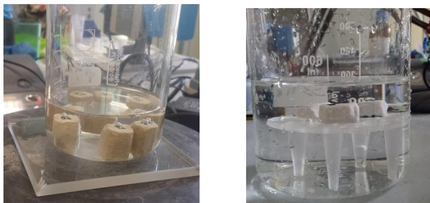
*Figura 60 - Trattamento ad immersione di campioni cubici di biomicrite (sinistra) e di marmo (destra) con soluzioni acquose di AmEtOx.*
