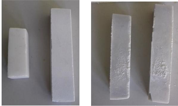
*Figura 57 - Campioni di marmo prima (sinistra) e dopo (destra) il trattamento termico di invecchiamento.*
