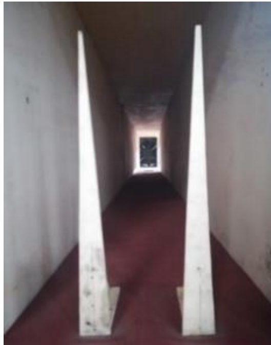
Figura 3.8. Spires e carta abrasiva installati nella sezione di sviluppo della galleria DICAAR
