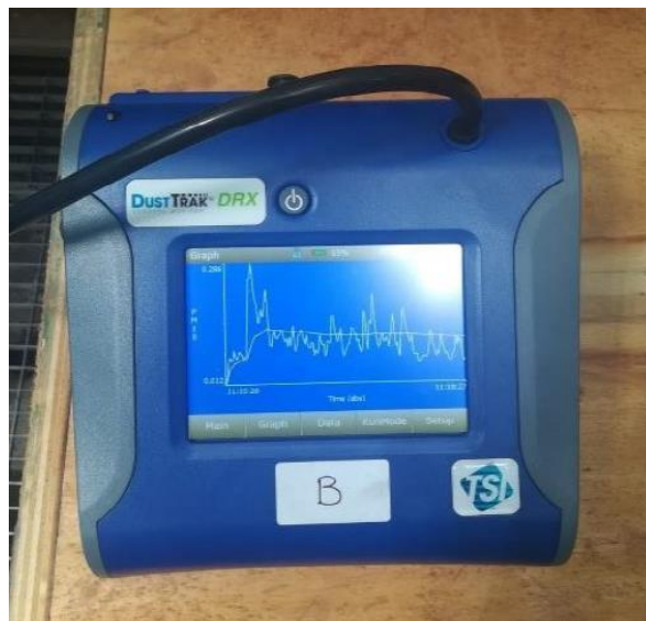
Figura 3.5. Analizzatore di polvere DustTrak DRX utilizzati nel corso dello studio sperimentale
