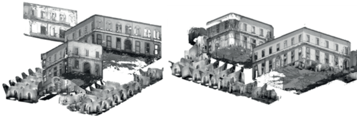
Torre Annunziata (NA), di Torre Annunziata, rilievo con Laser Scanner e modelli 3D con mesh (Rilievi di E. Fiore, E. Pilia, L. Veronese; elab. E. Pilia).
