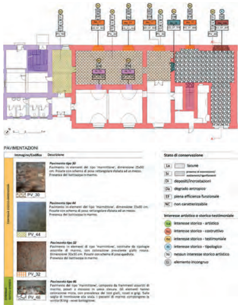
Fig. 110 - Cagliari, Caserma Livio Duce, edificio 7, mappatura delle pavimentazioni con la codifica mediante metodologia raumbuch delle tipologie, dello stato di conservazione e la valutazione dell'interesse culturale per ciascun elemento. Si noti il valore testimoniale assegnato alle pavimentazioni in marmettoni (resp. sc. D.R. Fiorino, elab. D.R. Fiorino, E. Pilia, 2015).
