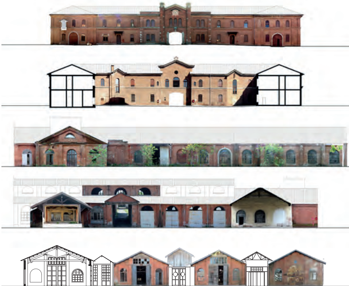
Fig. 187 - Pavia, ex Arsenale, rilievo di alcuni edifici antichi dell'Arsenale, valutazione dello stato di conservazione delle strutture, e restituzione tridimensionale con le strutture lignee delle coperture (Laboratorio di Architettura per il costruito, Corso di studi in Architettura-Architettura delle Costruzioni, a.a. 2015-2016; docenti R. Neri, E. Garavaglia, C. Campanella, S. Croce).
