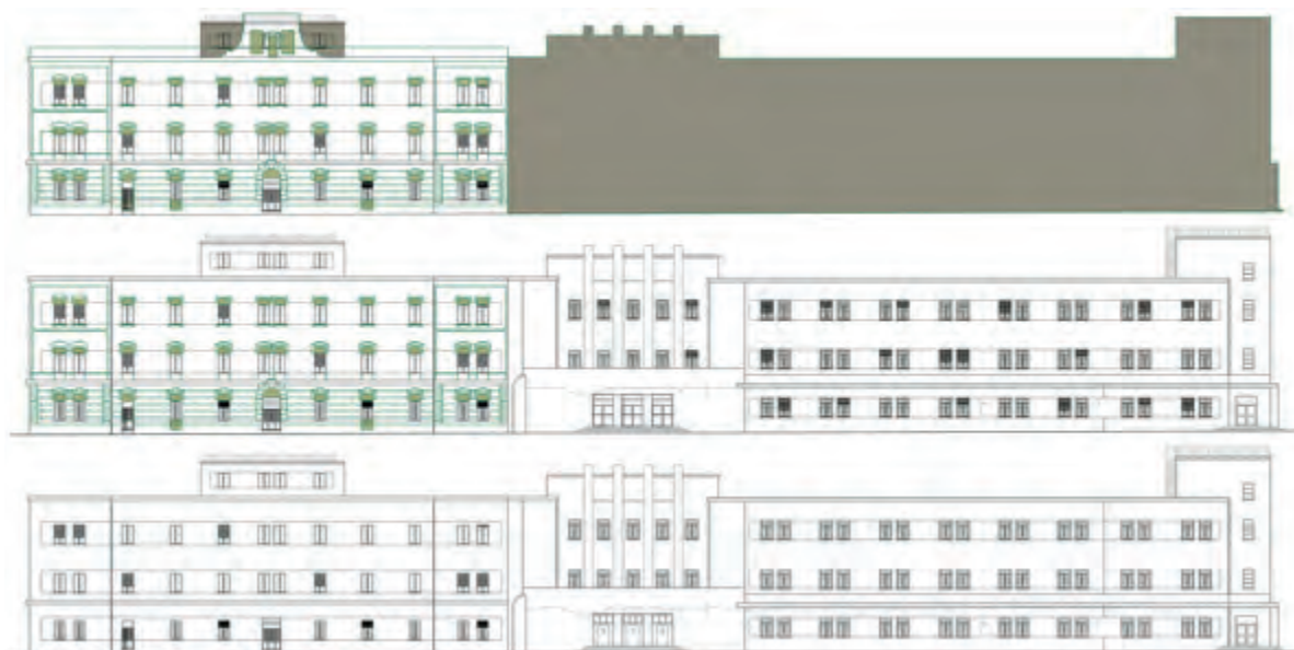
Fig. 144 - Elmas, ex Aeroporto Militare, Caserma Avieri (PG08-PG09). In alto, prospetto, agg. Sgt. Sittinieri-Angius, scala 1:100 (fonte Archivio Aeronautica Militare, Manufatti ceduti). Sotto, analisi delle addizioni, trasformazioni e adeguamenti formali a seguito dell'ampliamento e costruzione della nuova ala (elab. grafica F. Crobu, 2016).
