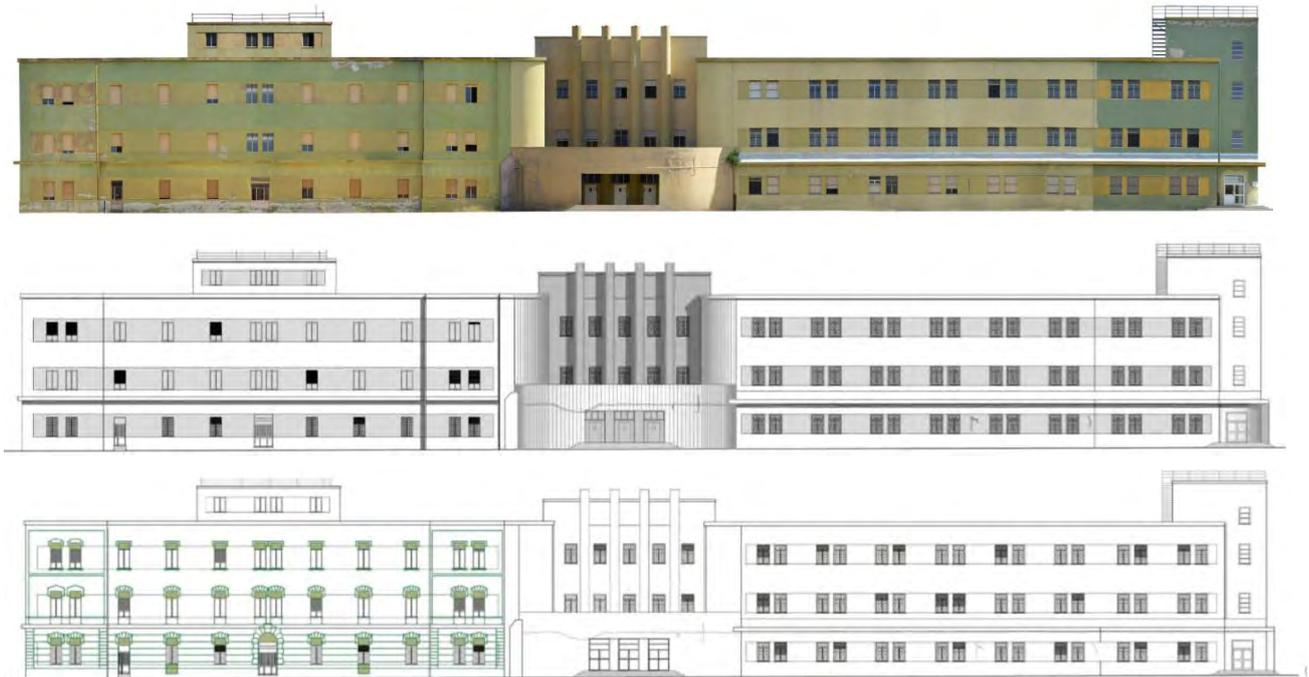
Fig. 6 - Ex Padiglione alloggi sottufficiali (PG08) e Caserma Avieri (PG09). In alto (a) fotomosaico del prospetto ovest; al centro (b) restituzione grafica del rilievo dello stesso prospetto; in basso (c) analisi delle trasformazioni storiche del medesimo prospetto sulla base del confronto con l'iconografia storica e la documentazione archivistica rinvenuta (elaborazione F. Crobu).
