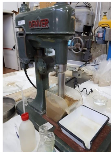
Figura 3.13 – Cella di flottazione Denver utilizzata per le prove di laboratorio.
