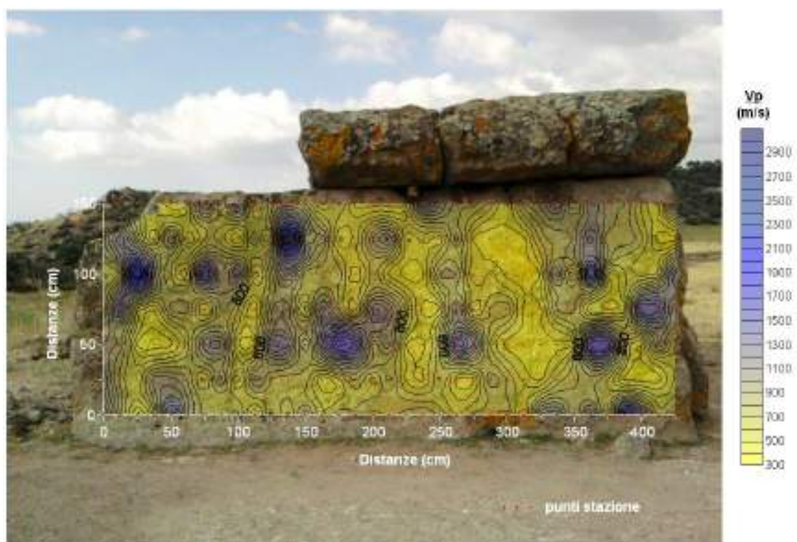
Fig. 3. MORES – Dolmen di Sa Coveccada. Paramento sud – mappa della distribuzione delle velocità di propagazione dell'impulso ultrasonico longitudinale ( V_p ).
